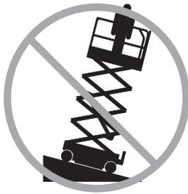
Ne pas relever la nacelle tant que la machine n'est pas sur une surface ferme et plane.
